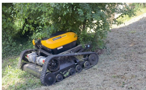
Le Robocut S300 peut attaquer les broussailles, mais de petit diamètre (autour des 2 cm).
