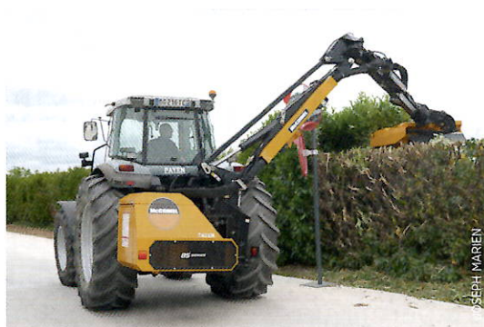
L'épareuse McConnell PA6585 présentée, en partenariat avec Groeneveld-BEKA, avec un bras hydraulique avancé et télescopique VFR est équipée d'un graissage centralisé, un gain de temps pour les gros utilisateurs.
