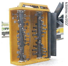
La tête de broyage McConnell Twincut, dont les deux rotors tournent en sens inverse.
