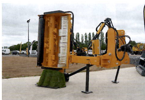
Le rotor est de type hélicoïdal à effet aspirant, et les marteaux sont polyvalents.
